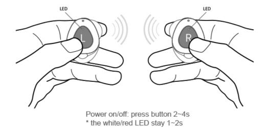
Marche - Arrêt : appuyer sur le bouton pendant 2 à 4 secondes \* La LED banche / rouge reste allumée 1 à 2 secondes Appairage
