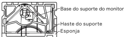
2. Retirar as duas partes da base, remover a esponja que está a cobrir a parte de trás do monitor e premir o botão para remover a placa do suporte.
