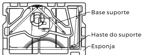
2. Retirar as duas partes da base, remover a esponja que está a cobrir a parte de trás do monitor e premir o botão para remover a placa do suporte.
