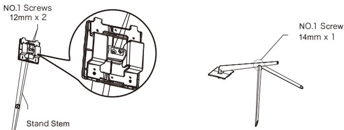
4. Inserir a placa do suporte na abertura na parte de trás do monitor. Deve fazer um clique quando encaixada. Assegurar que a base está fixada com firmeza na parte de trás do monitor, seguidamente remover o monitor da restante secção de esponja e colocá-lo em cima de uma mesa ou secretária conforme desejar.
