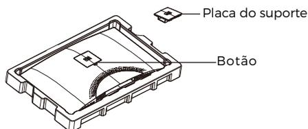
3. Usar uma chave de fendas e dois parafusos N° 1 12 mm para fixar a placa do suporte à haste. Seguidamente, usar os restantes parafusos de 14 mm do suporte para fixar a base ao suporte.
