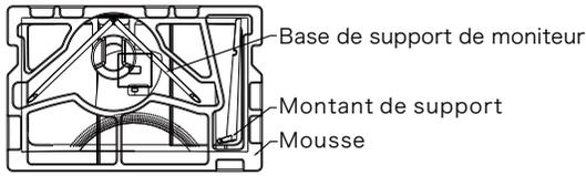
2. Prendre les deux parties du support, retirer la mousse recouvrant l'arrière du moniteur, et appuyer sur le bouton pour retirer la plaque de support.
