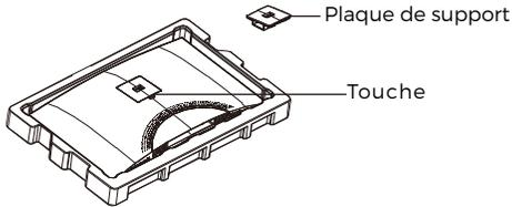
3. Utiliser un tournevis et deux vis 12 mm N° 1 pour fixer la plaque de support sur le montant. Ensuite, utiliser les vis 14 mm restantes pour fixer la base sur le montant.
