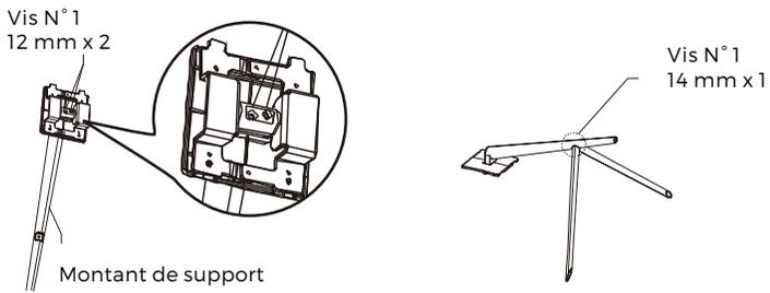
4. Insérer la plaque de support dans l'ouverture à l'arrière du moniteur. Il doit cliquer quand il est en place. S'assurer que le support est bien fixé sur l'arrière du moniteur, puis retirer la mousse restante du moniteur, et le poser sur une table ou un bureau selon le désir.
