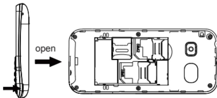
**Napomena:** Isključite uređaj i prekinite vezu sa punjačem pre nego što izvadite bateriju. Koristite isključivo bateriju kompatibilnu sa ovim telefonom.
