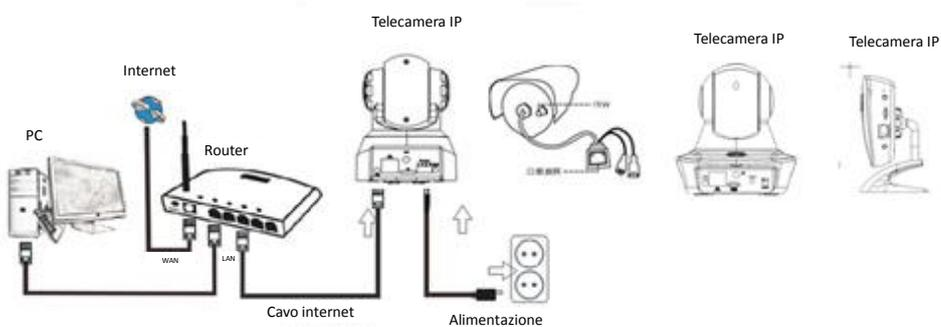
Collegare il cavo di alimentazione alla telecamera IP e attendere circa 2 secondi fino a quando la spia verde si accende in modo permanente. Dopo altri 10 secondi, la spia gialla inizia a lampeggiare: la fotocamera eseguirà la rilevazione IP automaticamente.
