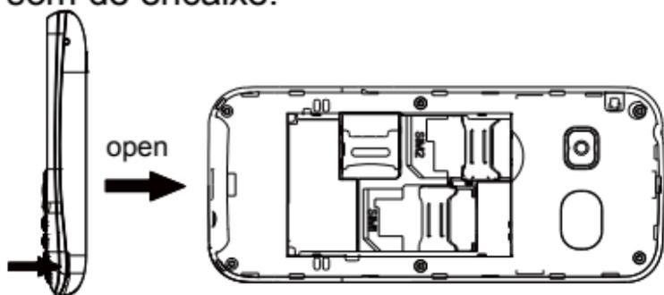
**Observação:** Encerrar todos os dispositivos e cortar a ligação com o carregador quando retira a bateria. Usar apenas a bateria apropriada para este telefone.
